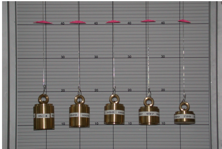
Fig.1 : Montage utilisé pour l'expérience de fluage
