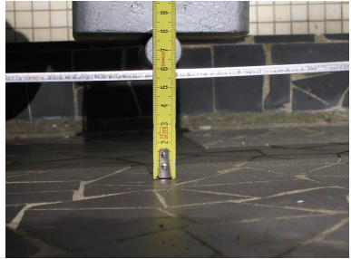
P = 160 \text{ N} , distance entre appuis 50 cm
