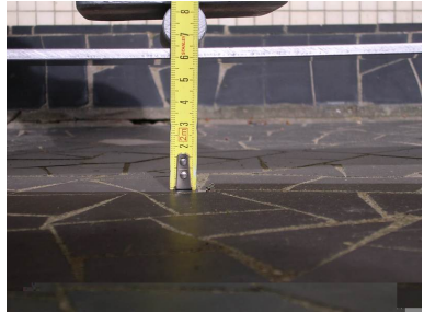
P = 160 \text{ N} , distance entre appuis 40 cm
